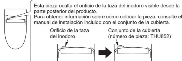
Esta pieza oculta el orificio de la taza del inodoro visible desde la parte posterior del producto. Para obtener información sobre cómo colocar la pieza, consulte el manual de instalación incluido con el conjunto de la cubierta.
